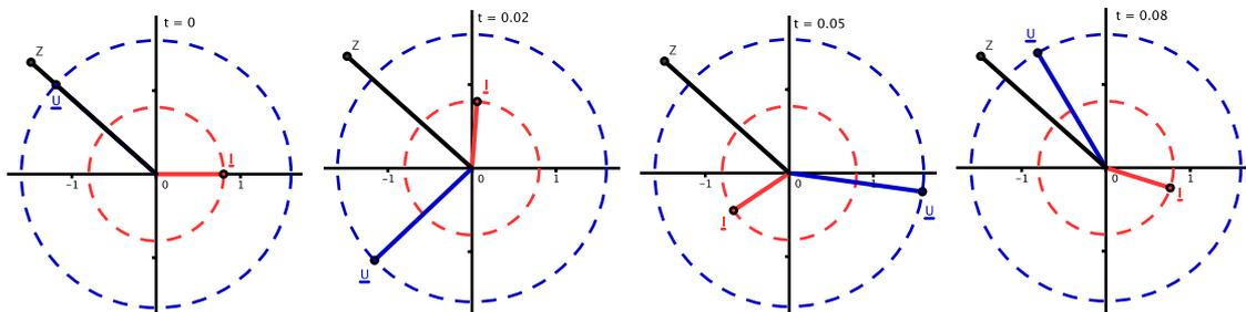
$Z$  est invariant alors que  $\underline{U}$  et  $\underline{I}$  effectuent des rotations sur deux cercles centrés à l'origine et de rayon respectif  $U_0$  et  $I_0$  à une vitesse angulaire égale et constante.
