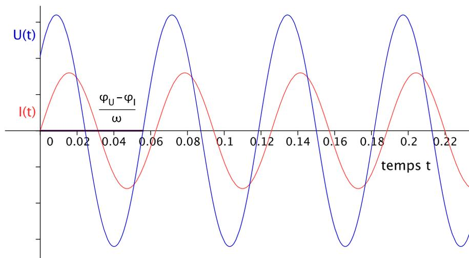
Graphes de  $I(t)$  et  $U(t)$  avec  $I_0 = 0.8$ ,  $U_0 = 1.6$ ,  $\omega = 100$ ,  $\varphi_I = 0$  et  $\varphi_U = 0.7$ .
