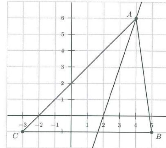
On peut également déterminer l'équation d'une bissectrice intérieure d'un triangle à partir de sa construction à la règle et au compas. En effet lorsqu'on additionne deux vecteurs de même norme, leur somme est un vecteur directeur de la bissectrice de l'angle qu'ils forment (car une diagonale d'un losange est également une de ses bissectrices).
