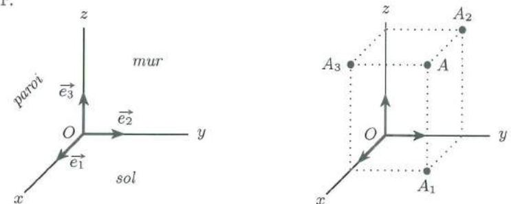
Nous notons  $A_1$ ,  $A_2$  et  $A_3$  les projections d'un point  $A$  parallèlement aux axes sur le sol, le mur et la paroi.
