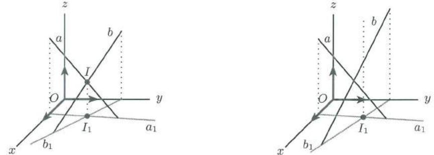
Si le point d'intersection  $I_1$  des droites  $a_1$  et  $b_1$  n'est pas situé à la verticale du point d'intersection apparent, alors les droites  $a$  et  $b$  sont gauches.
