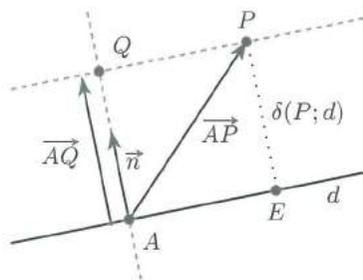
La distance du point  $P$  à la droite  $d$  est  $\delta(P; d) = \|\vec{AQ}\|$  où  $\vec{AQ}$  est la projection orthogonale du vecteur  $\vec{AP}$  sur le vecteur normal  $\vec{n}$ .
