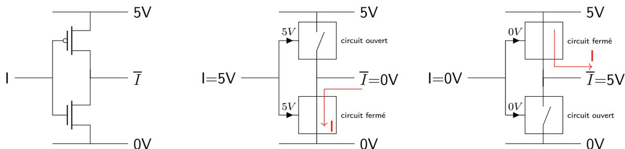
FIGURE 3 – Schéma d'un inverseur
