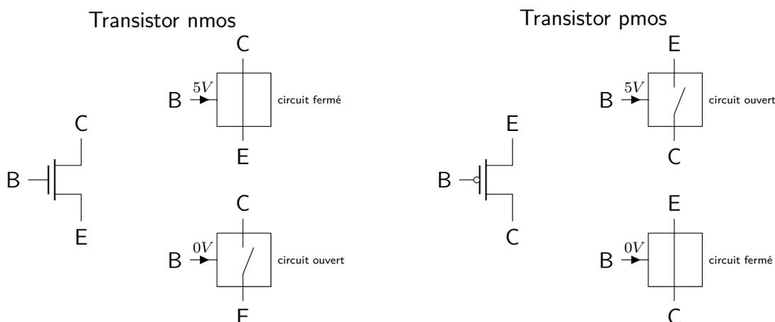
FIGURE 2 – Le courant circule entre C et E lorsque B est sous tension dans un transistor n-mos. Il ne circule pas lorsque B est sous tension dans un transistor p-mos.
