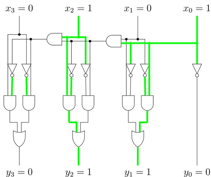
FIGURE 7 – Illustration de  $5 + 1 = 6$ . En vert, les parties du circuit sous tension.
